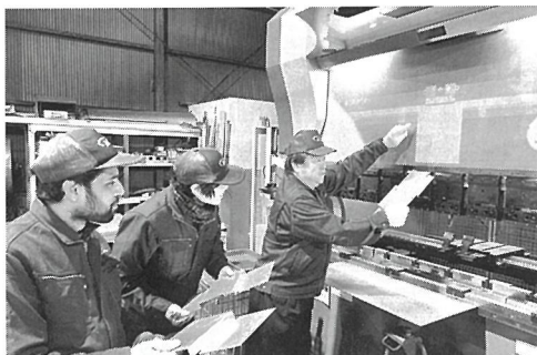
金属板を折り曲げるプレスベンダー機を使った作業
