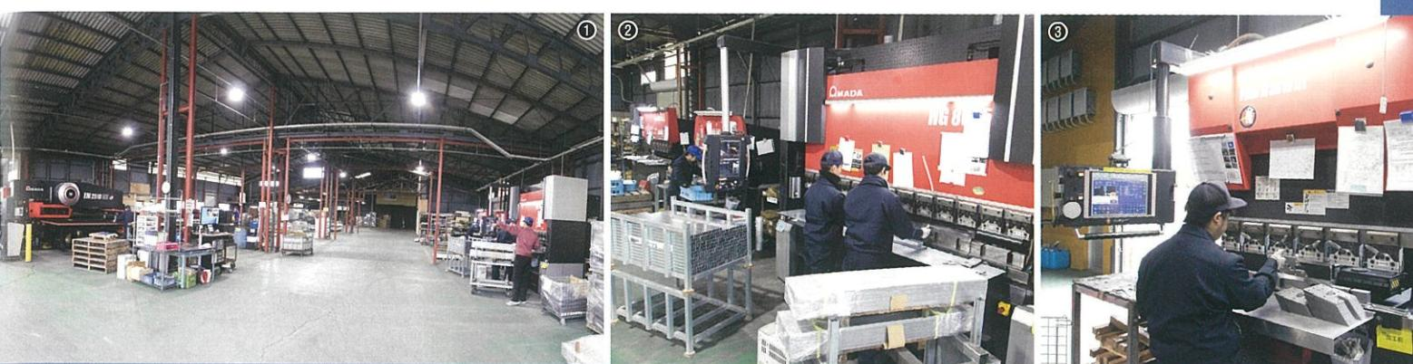
①板金工場として2019年に開設した大谷工場／②曲げ工程にはHG-8025(手前)をはじめ6台のベンディングマシンを設備／③小物部品の曲げ加工に対応するベンディングマシンFMBII-3613NT
