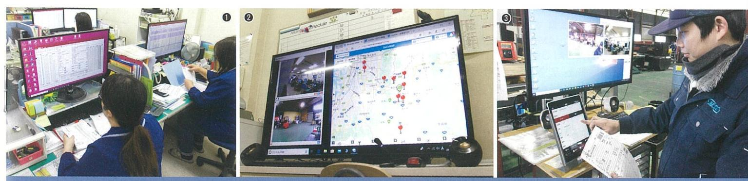
①生産管理システムWILLを導入し、進捗・実績情報の一元管理とトレーサビリティーを実現した／②本社工場の事務所と大谷工場はいつでもビデオチャット(画面左)ができるほか、GPS機能とGoogleマップが連動し、自社便の現在位置と納品先がひと目でわかる(画面右)／③タブレット端末のカメラ機能で作業指示書のバーコード読み取り、着手・完了情報を入力する
