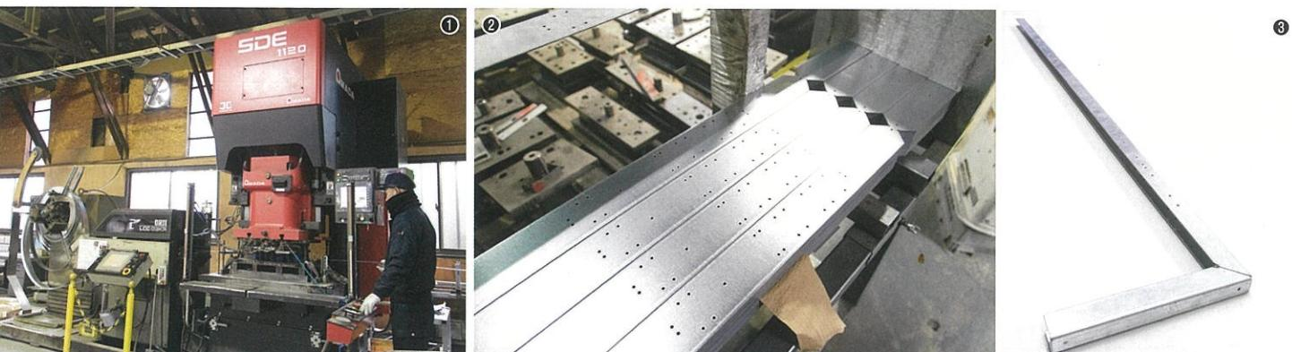
①サーボプレスSDE-1120による順送加工。多数制御システムを用いたランダムピッチ送り方式を採用している／②プレス加工後の鋼製家具用部品。ステージ交換式順送金型により穴位置ちがいや寸法ちがいに対応する／③プレス加工後、曲げ加工と溶接まで行った鋼製家具用部品
