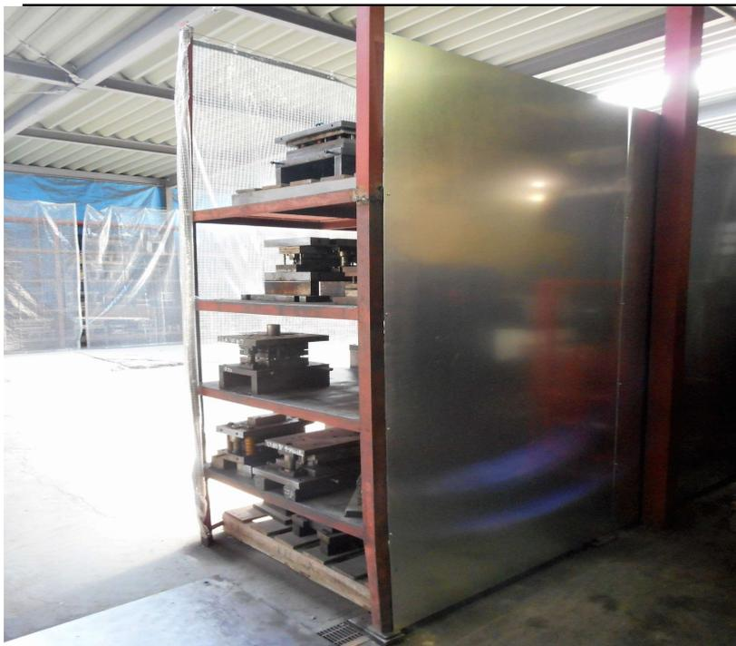
現在、金型管理、整理をしている鉄ラックですが、正面カーテン側から金型を取る際、加工機械に面する裏側が従来のままだと金型落下の危険性が考えられたので、裏側に鉄板を張り落下防止と共に金型破損を防ぐ改善策を取りました。（改善日4/28日）
